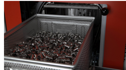
Nettoyage dans une caisse en tôle perforée
